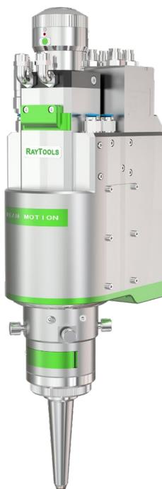
GF101F, 该款高功率三维激光切割头可适配 3.3kw/4kw 的激光器, 适配 QBH 的接口, 满足机器人对三维金属加工的需求。内置随动, 调节范围 $\pm 10\text{mm}$ , 且具备自动调焦功能, 调节范围 $\pm 5\text{mm}$ 。该设备使用了优良的水冷设计方案及气路的通道, 能较好的提高加工效果。轻量化设计, 减少机器人负载。同时又高度密封, 防止灰尘污染, 喷嘴细长设计, 减少工件干涉。最大优点是具备内置随动功能的同时还具有自动调焦功能, 可满足完美切割不同厚度的需求。
