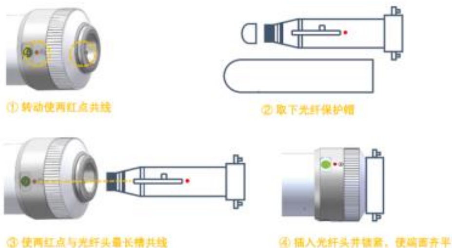
图 2-3 QBH 与光纤连接方法
