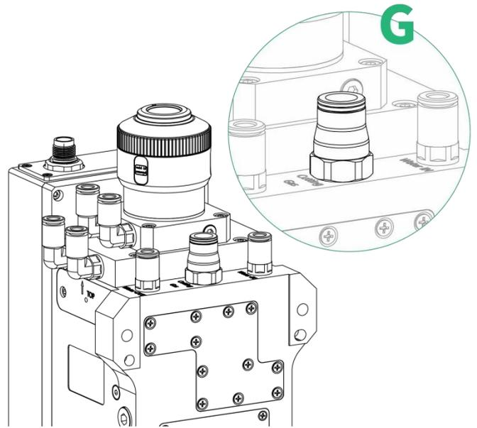
气体中的杂质如碳氢化合物和水蒸气会损坏镜片，引起切割功率波动同时也会导致工件切面前后不一致。下表是推荐使用的切割气体规格
