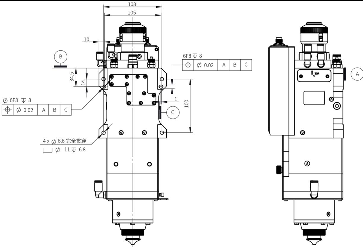
**i** 建议按照要求，将激光头垂直于加工面安装，并保证螺钉紧固，避免激光头振动。
