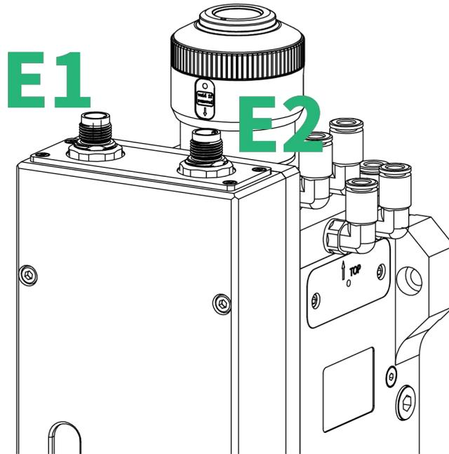
将编码器线缆连接到 E1 接口（12 芯），动力限位线缆连接到 E2 接口（8 芯），预留合适的长度后，将线缆穿入机床线缆履带槽内固定好。
