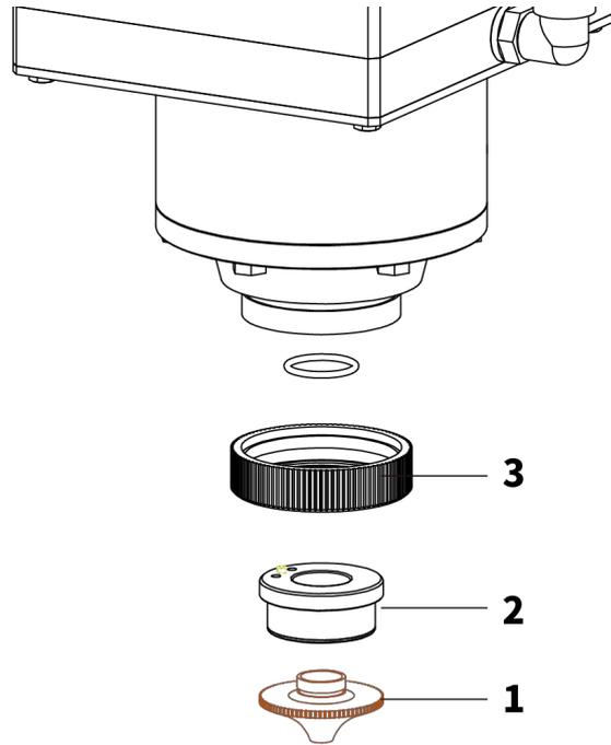
清洁陶瓷体/环的脏污，必要时更换；喷嘴因激光束受损或发生碰撞后需要更换喷嘴。
