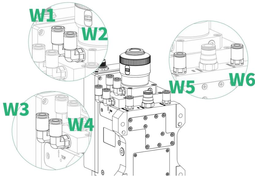
冷却水进出的方向可以参照图示进行连接。
