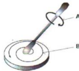
A 棉签旋转方向 B 圆弧运动清洁镜片
